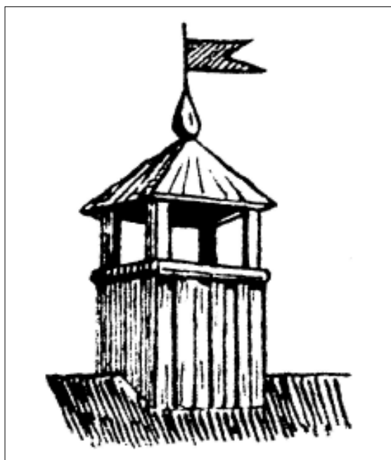
Senesnėse žemaičių trobose siaurėjantis į viršų kaminas būdavo daromas iš karčių, išpintų vytelėmis ar virbais ir iš abiejų pusių apkrėstas molio, todėl virš stogo buvo apkalamas lentomis, įrengiant keturšlaitį arba dvišlaitį stogelį [10: 71]
